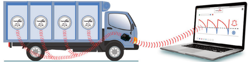
Die Sensoren im Kühlraum übermitteln die Temperaturdaten via Bluetooth Low Energy an die Telematik-Einheit und werden im Dashboard des Anwenders visualisiert. Bilder: PLT GmbH
